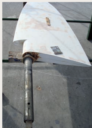
El timón, desmontado. Se puede apreciar lo reforzada que es la mecha para la reducida eslora del barco.
