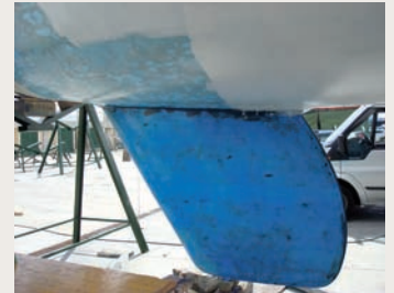
Aplicando epoxy al casco y a la quilla.
