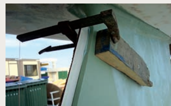
Base utilizada para perfilar la quilla a 45 grados.
