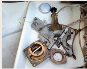
Casquillo superior del timón (en bronce) con la biela (en aluminio).
